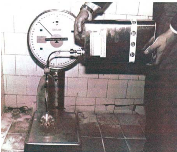
Obrázky Plnenie esterového oleja. Príprava dávky oleja bez stku s okolitým vzduchom. Plnenie pri odstavenom kompresore po pump down (podtlak v okruhu)
