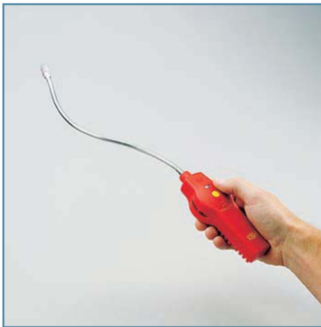
Príklad 21: Záverečná kontrola úniku pomocou elektronického detektora
