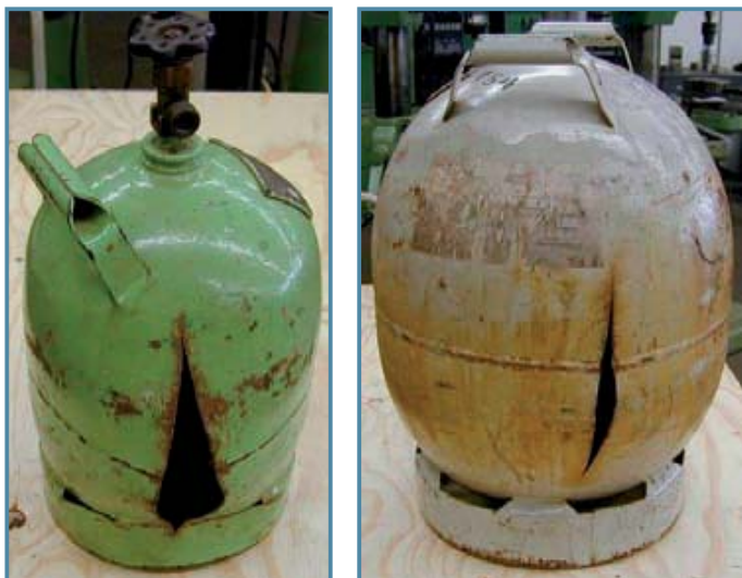
Príklad 3: Príklady vybuchnutých tlakových fliaš s chladivom
