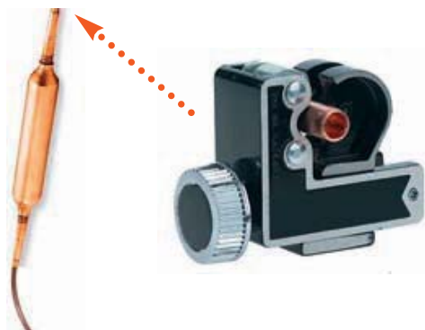
Príklad 10: Odrezanie filterdehydrátora
