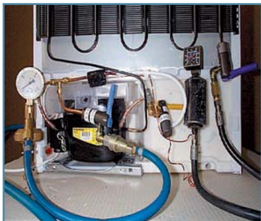
Príklad 15: Zostava na test výkonu motorkompresora
