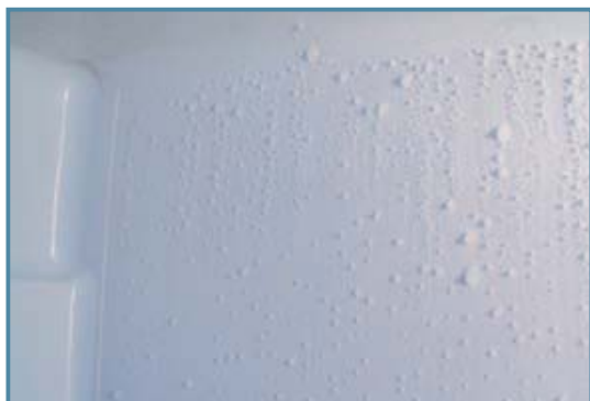
Príklad 3a: Stena chladničky (výparník) s námrazou
