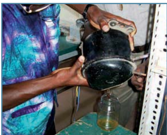
Príklad 17: Odoberanie vzorky oleja z hermetického kompresora
