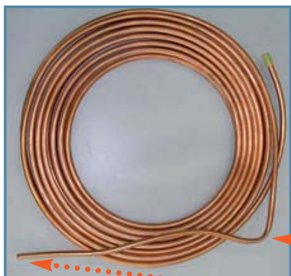
Príklad 1: Nevhodné zaobchádzanie s rúrkami
