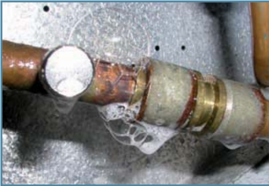
Príklad 18: Bublinky indikujúca únik
